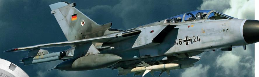
*Eine der Hauptaufgaben der Tornados der deutschen Luftwaffe ist das Ausschalten von Radarstationen, die eine Gefahr für anderen Flugzeuge darstellten. Dazu ist er mit Störsendern (unter dem Flügel, ganz außen) und HARM-Raketen ausgestattet, die Radarquellen ansteuern.*
