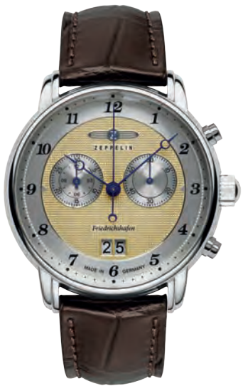
8584-5* | Chronograph mit Groß-Datum Chronograph Big Date Ronda 5020.B | 5 Jewels | 12 Hours & 30 Min. Totalizer | Mineral Crystal K1 | wr 5 atm | Ø 40 mm
